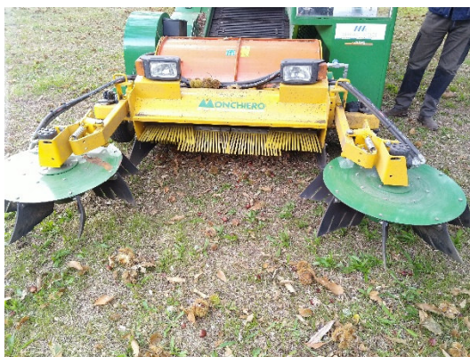
Figura 16. Equipamento para colheita mecânica da castanha, Sernancelhe Foto por: Suzana Fonseca
